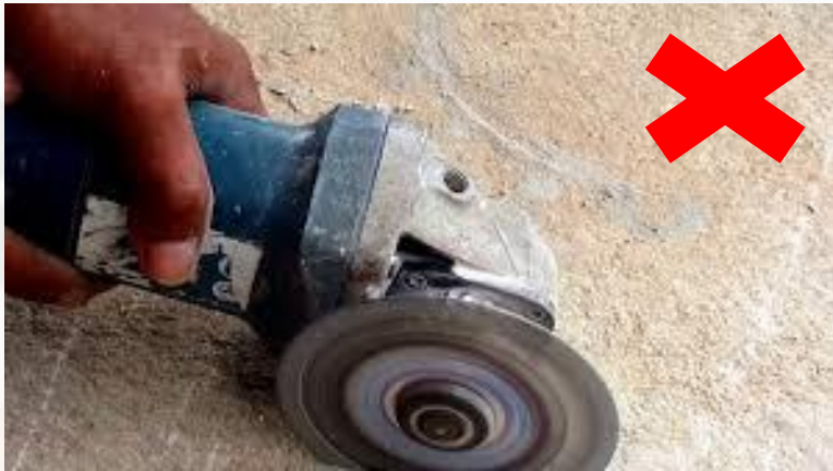
เครื่องมือที่ไม่มี Safety Guard (ไม่ปลอดภัย)
